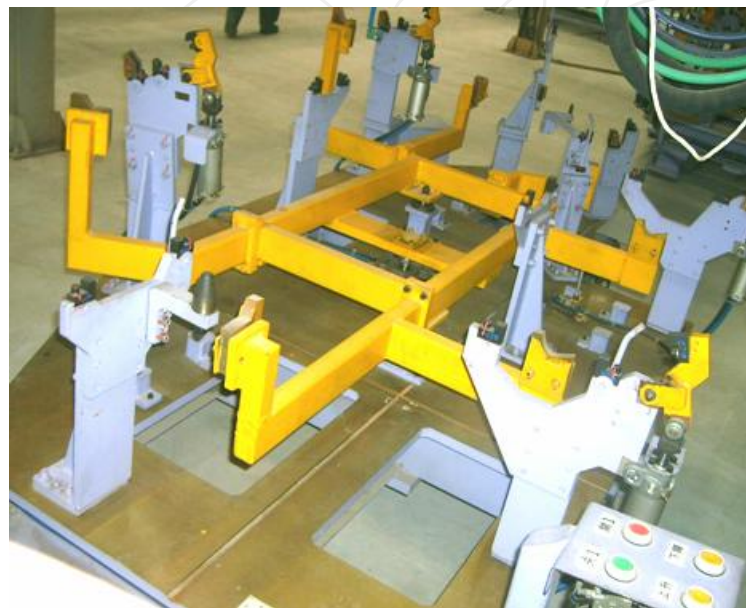
焊接夹具-保证焊接尺寸
